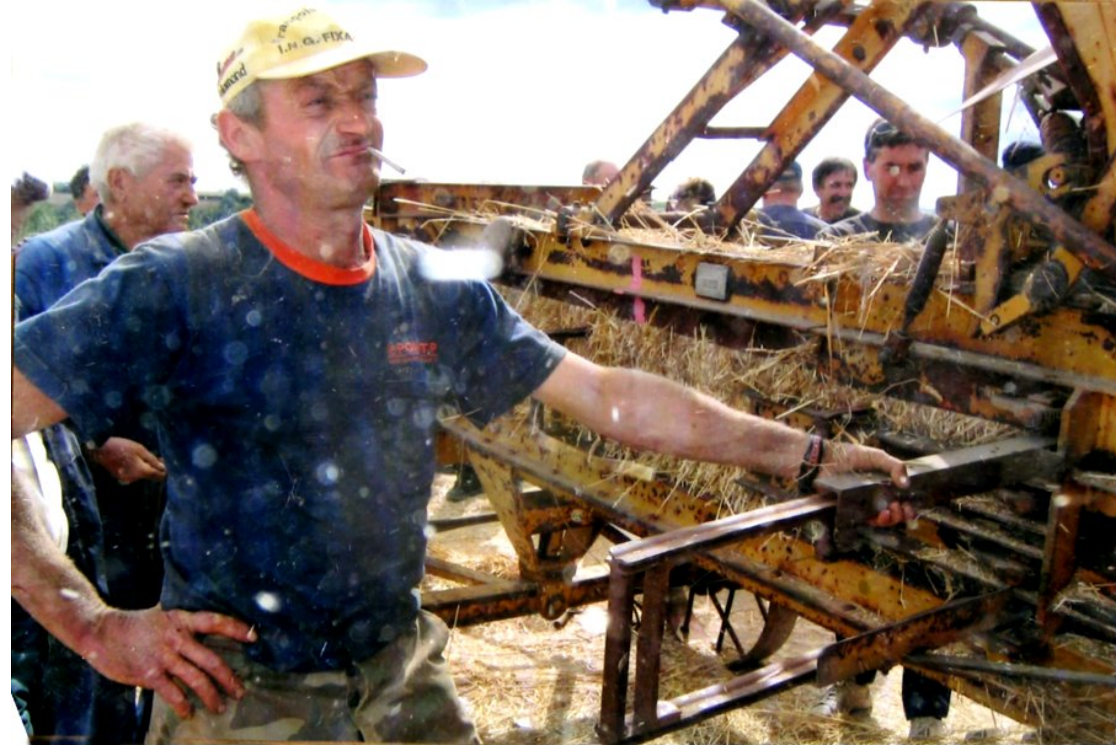
François à l'aiguillage; un travail sérieux et poussiéreux : Renvoyer le fil de fer au côté opposé dans l'aiguille plantée quand le piston recule sinon c'est la casse .
